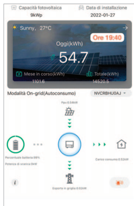
Esempio di produzione giornaliera di un impianto fotovoltaico monofase e relativo monitoraggio dell'energia utilizzata dall'abitazione.
