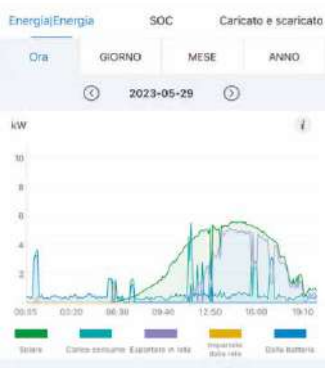
Esempio di produzione giornaliera di un impianto fotovoltaico monofase e relativo monitoraggio dell'energia utilizzata dall'abitazione.
